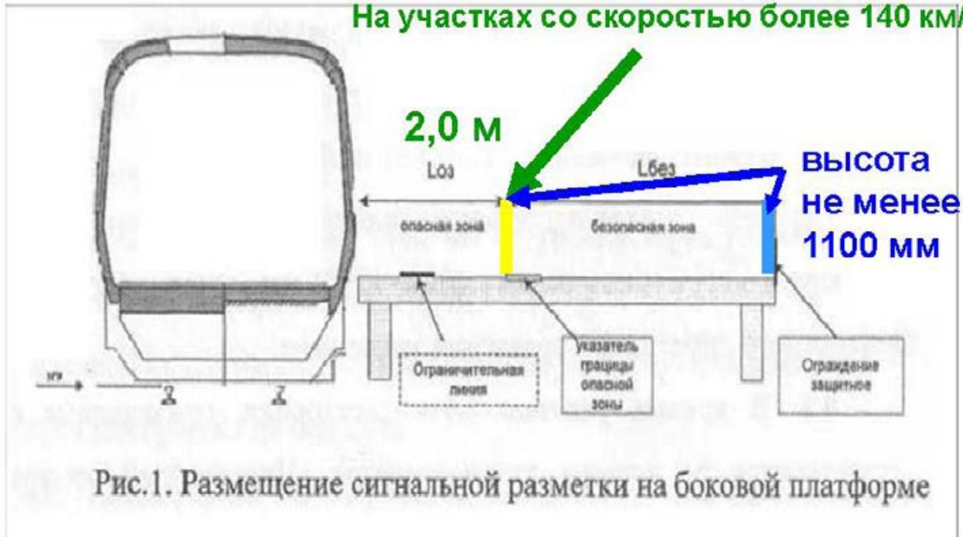
Рис.1. Размещение сигнальной разметки на боковой платформе
