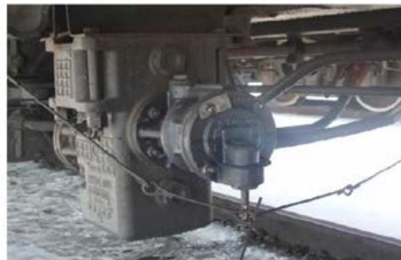
Положение ручек концевых кранов.
