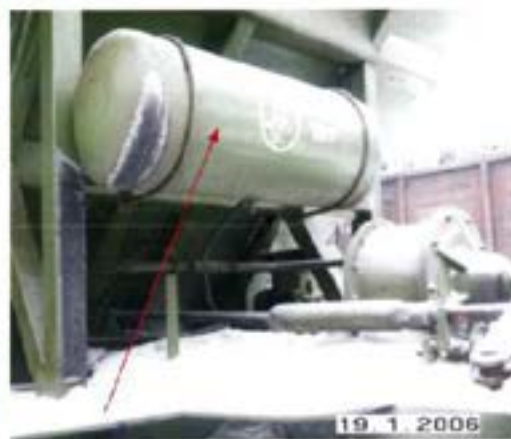
Запасной резервуар модели Р7-135 (минераловоз)
