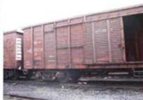
Не закрытые двери вагона
