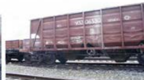
Четырехосный крытый вагон — хоппер для перевозки цемента
