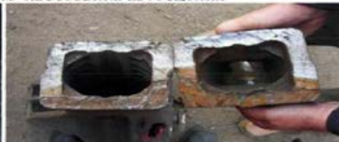
Излом хвостовика автосцепки по старой трещине
