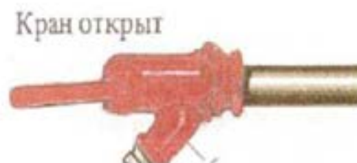
Положение ручек концевых кранов.
