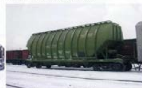
Хоппер для перевозки минеральных удобрений постройки БМЗ с разделным потележечным торможением.
