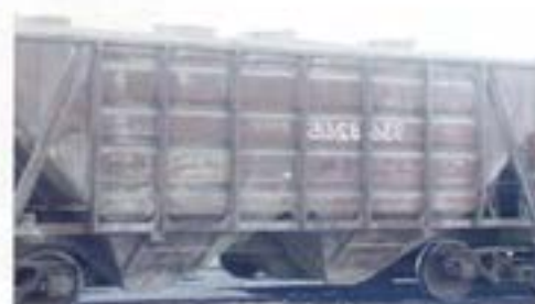
Четырехосный крытый вагон — хоппер для перевозки цемента
