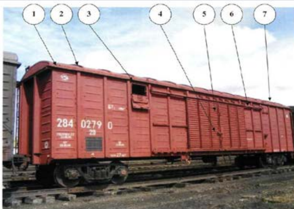
Четырехосный крытый вагон — хоппер для перевозки минеральных удобрений
