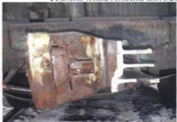
Излом большого зуба автосцепки из-за неправильного ведения поезда
