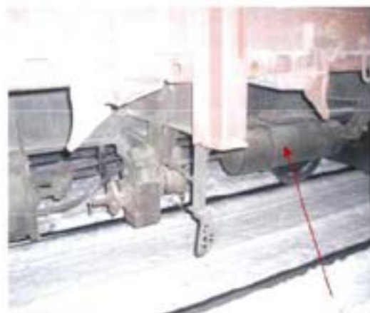
Запасной резервуар модели Р7-78 (полувагон)
