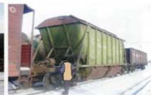
Четырехосный крытый вагон — хоппер для перевозки минеральных удобрений
