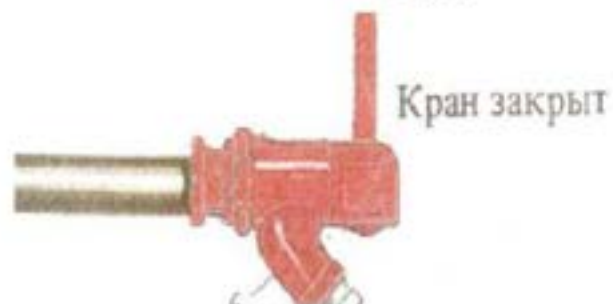
Положение ручек концевых кранов.
